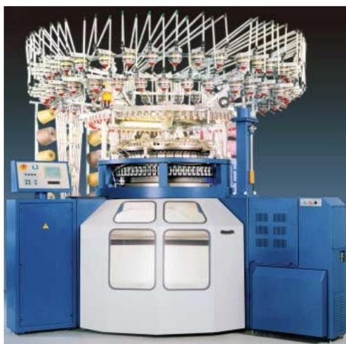
Tradizionale basamento Orizio modulare, rinnovato nella funzionalità, robustezza ed estetica, con nuovo pannello di controllo che permette la fruizione di nuove tecnologie ed integra il controllo macchina, la selezione degli aghi e le seguenti funzioni:
